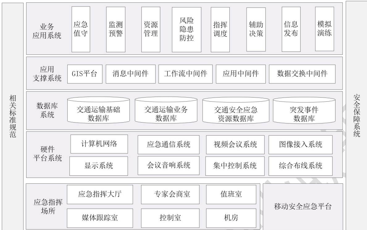
图 1 城市综合交通运行监测与安全应急指挥调度系统的物理架构
