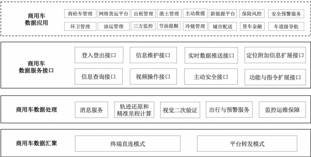
图1 商用车数据服务平台架构
