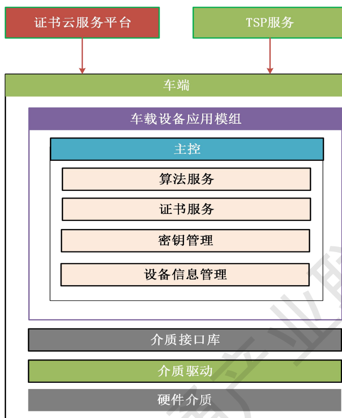
图1 密码设备应用调用模型
