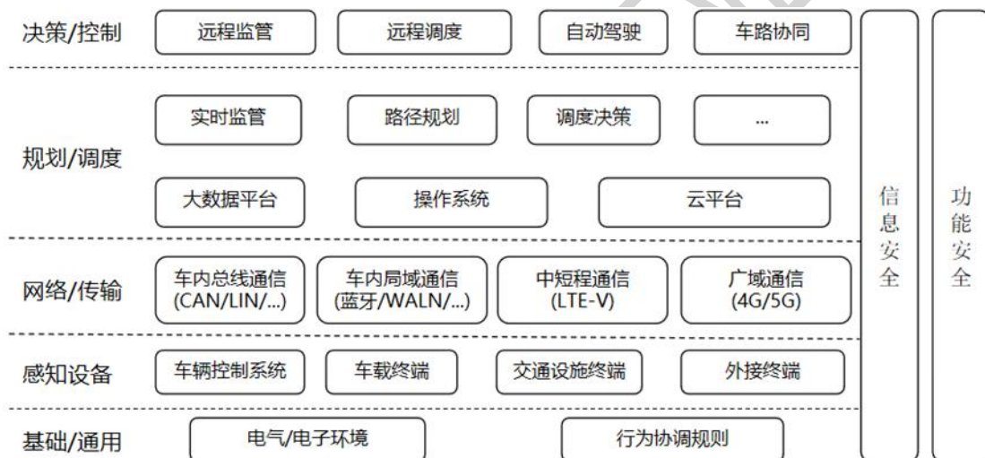
图 1 港口无人驾驶集装箱卡车控制产品物理结构
